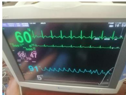
Figura 5. El departamento de biomédica del Hospital Universitario cuenta con un simulador de paciente para probar el funcionamiento de monitores.
