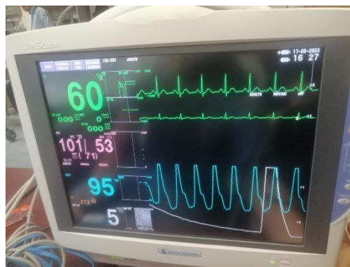
Figura 11. Prueba de funcionamiento adecuado antes de subirlo a área hospitalaria.
