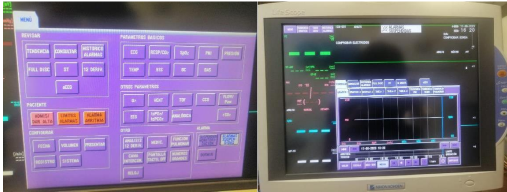
Figura 4. Al momento de encender el monitor, debemos comprobar el funcionamiento adecuado de la botonera, pantalla touch y leds.
