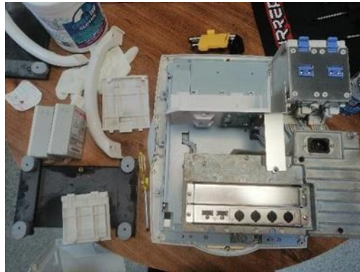
Figura 9. Desarmado de monitor de signos vitales.
