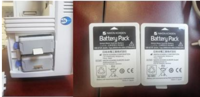
Figura 7. Los monitores de signos vitales suelen tener dos baterías extraíbles, estas tendrán un periodo de duración de máximo 2 años, dependiendo del uso del monitor, la duración de la batería sin que el equipo esté conectado a la corriente eléctrica va desde los 60 a 90 minutos.
