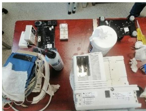
Figura 8. Para la limpieza de equipo médico se requiere de kit de limpieza que no sea corrosivo para el plástico o componentes electrónicos internos y no dejen residuos.
