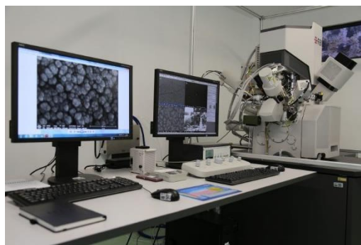
Figura 2.6 Microscopio electrónico de barrido (SEM) de doble columna marca FEI, Modelo SCIOS.
