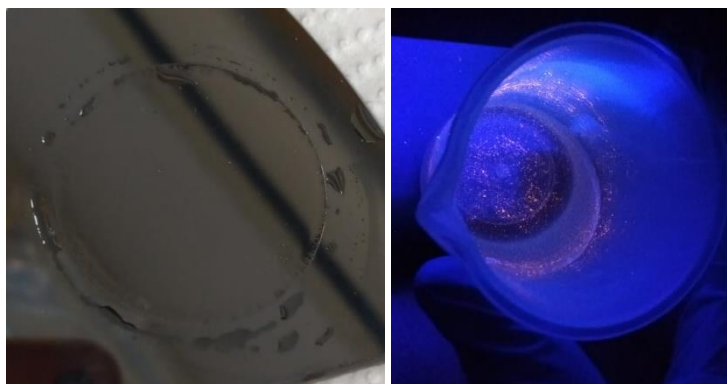
Figura 4.2.- Capa desprendida del sustrato por exceso de corriente (65 mA) para soluciones con HNO 3 .
