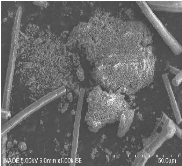
Figura 4.32.- Imagen SEM de polvos de Si con concentración de 1:3:12→10mA bajo tratamiento de oxidación escala de 50 μm.
