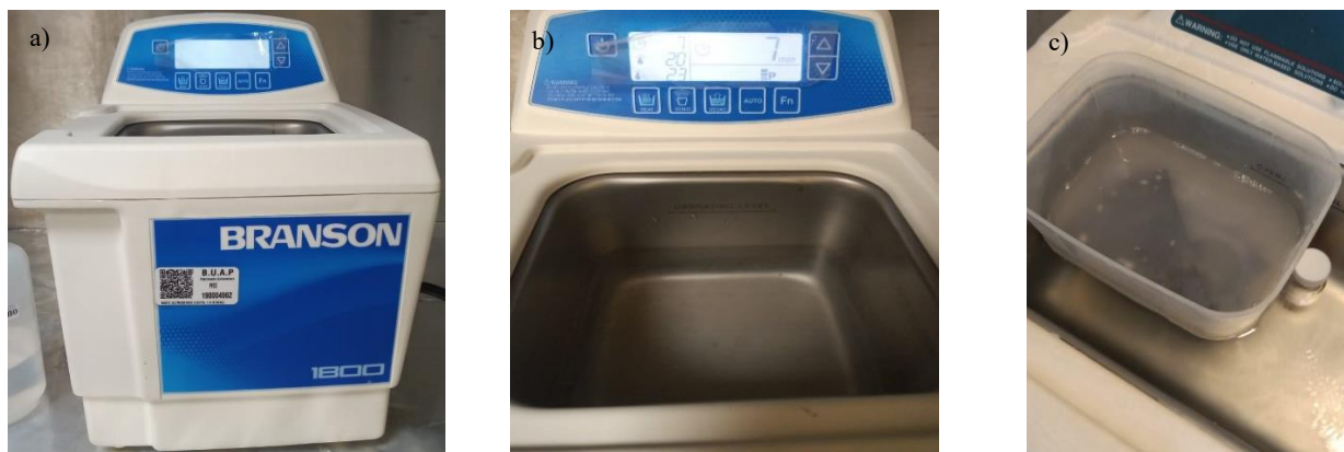
Figura 3.9.- a) Tina ultrasónica Branson cpx3800h; b) Nivel de H 2 O DI en tina ultrasónica; c) sustratos al final del proceso.
