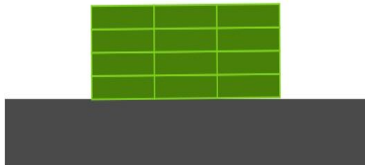
Figura 4.28: Representación esquemática de la forma del apilamiento las nano-hojas y placas en la formación de la pastilla, imagen propuesta a partir de los difractogramas.
