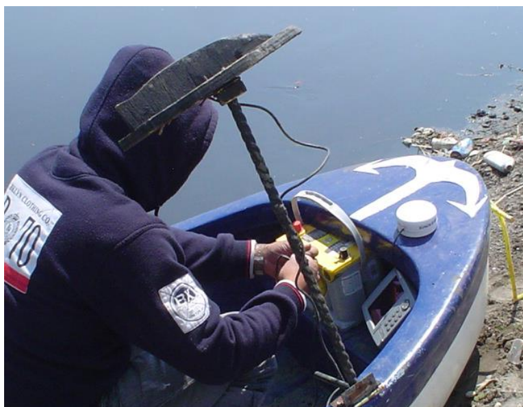
Fig. 3.2 Instalación de GPS en ecosonda
