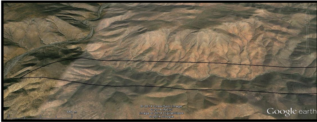
Figura 42. Drenaje dendrítico de los últimos 2 km de la zona 3 con una orientación NE-SO. Se observa que el cauce principal fluye sobre una falla geológica.
