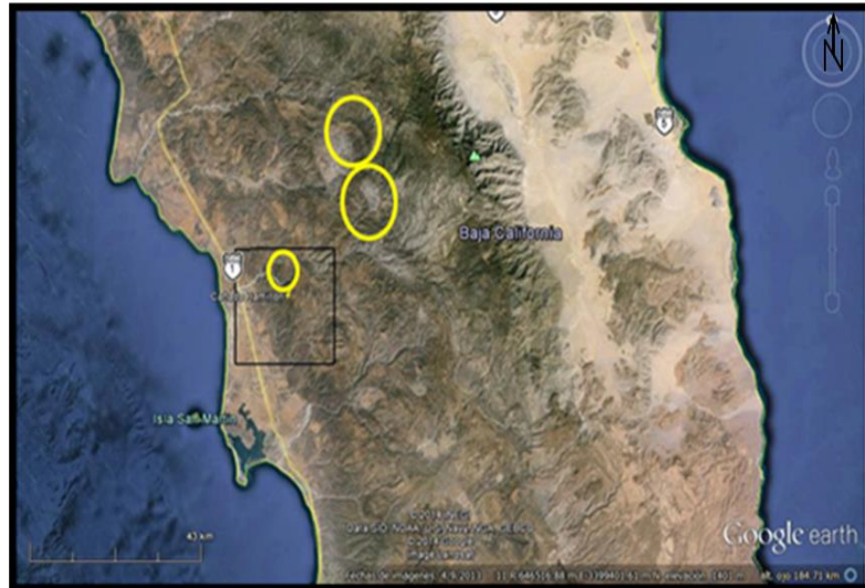
Figura 24. Se encierran en círculos color amarillo algunas de las anomalías que ven en el filtro de gradiente horizontal y cómo esos rasgos se notan superficialmente en un sistema de elevación digital.
