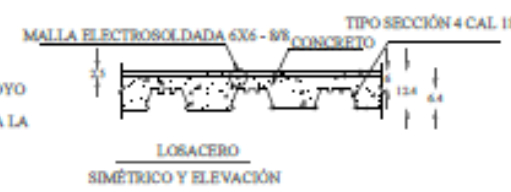
LOSACERO SIMÉTRICO Y ELEVACIÓN
