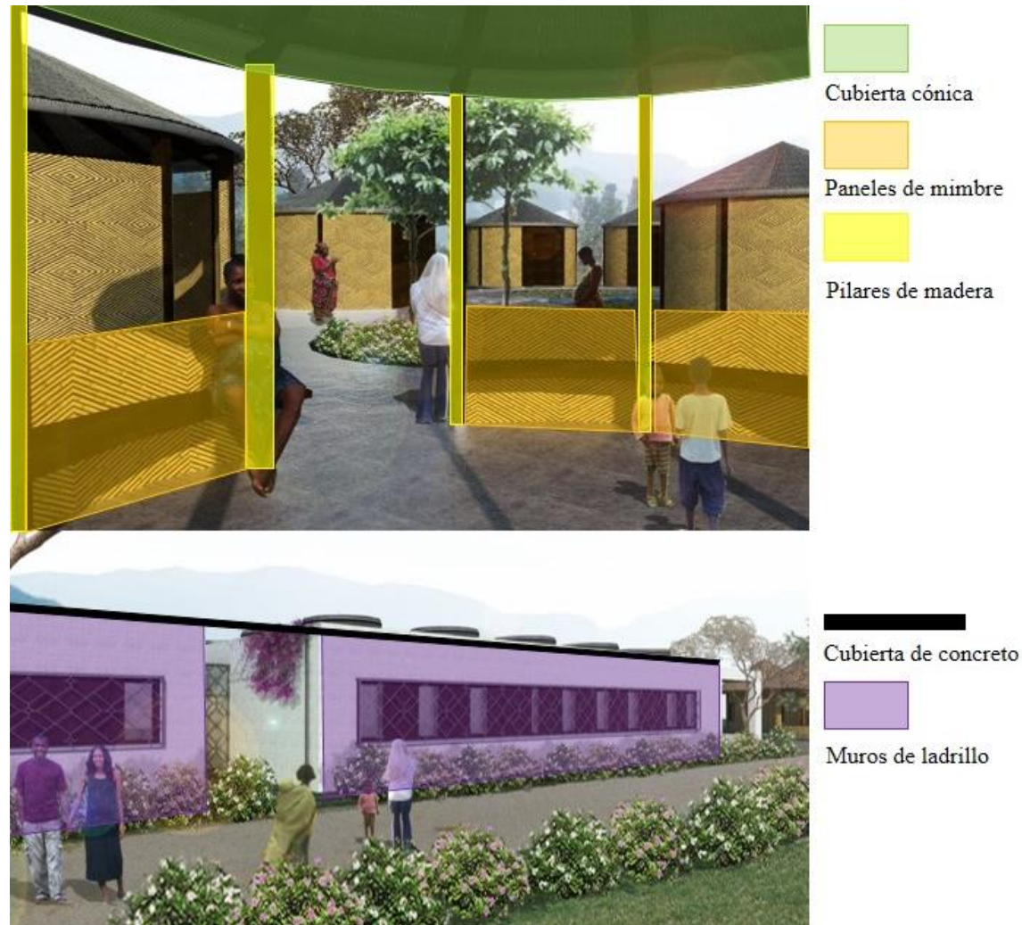
Imagen 20 Fuente: Archdaily Análisis estructural. "Chozas" del área de albergue (arriba). Edificios del área médica (abajo) Elaborado por: Sánchez D. (2013)
