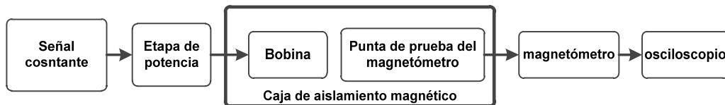
Figura 4.1: Diagrama a bloques de la etapa de caracterización del campo magnético generado por las bobinas.
