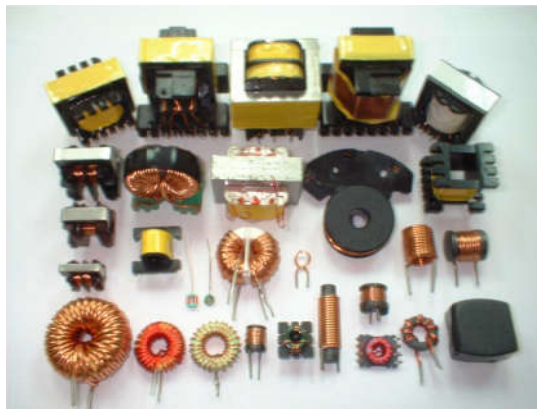
Figura 1.1: Diferentes tipos y formas de bobinas o solenoides con y sin núcleo.
