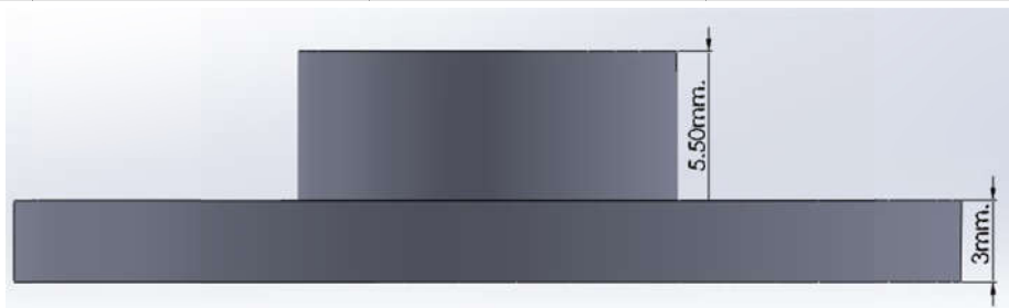
Figura C.3: Vista lateral de la pieza 1 del carrete diseñado en el software Solidworks y contruido por un aimpresora 3D.
