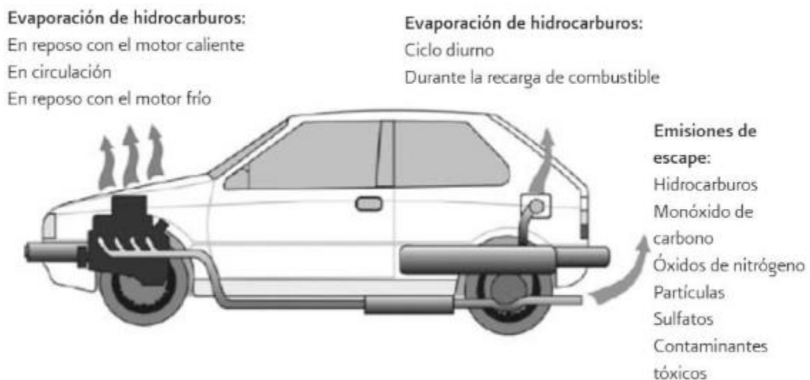
FIGURA 1.1. PROCESO DE EMISIÓN DE CONTAMINANTES EN VEHÍCULOS AUTOMOTORES
