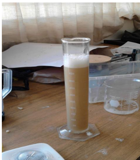
Figura 6. Prueba de espuma a partir de las saponinas obtenidas de la raíz.
