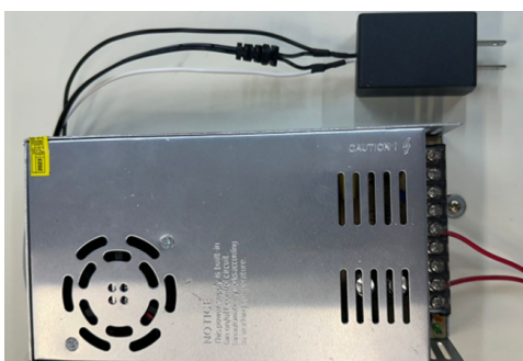
Figura 3.24: Fuente conmutada de 24V y 5V.
