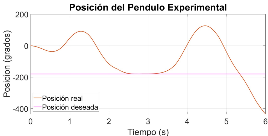
Figura 6.4: Gráfica de posición del péndulo con el controlador PD.
