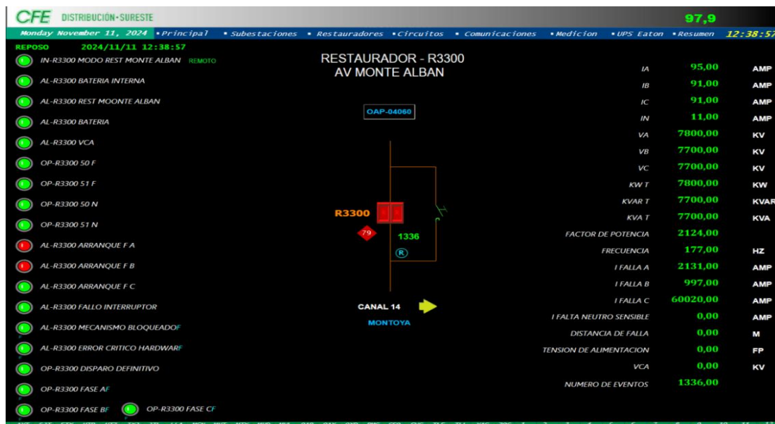
Figura 21 Interfaz de Diagrama único de dispositivo EPROSEC en Survalent para mayor comprensión visitar anexo E [captura de pantalla]
