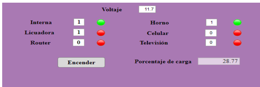
Figura 42 Encendido de cargas, tercer caso disminución de voltaje y disminución de solicitud de encendido de cargas, tres de seis cargas (elaboración propia Matlab 2022 academic)
