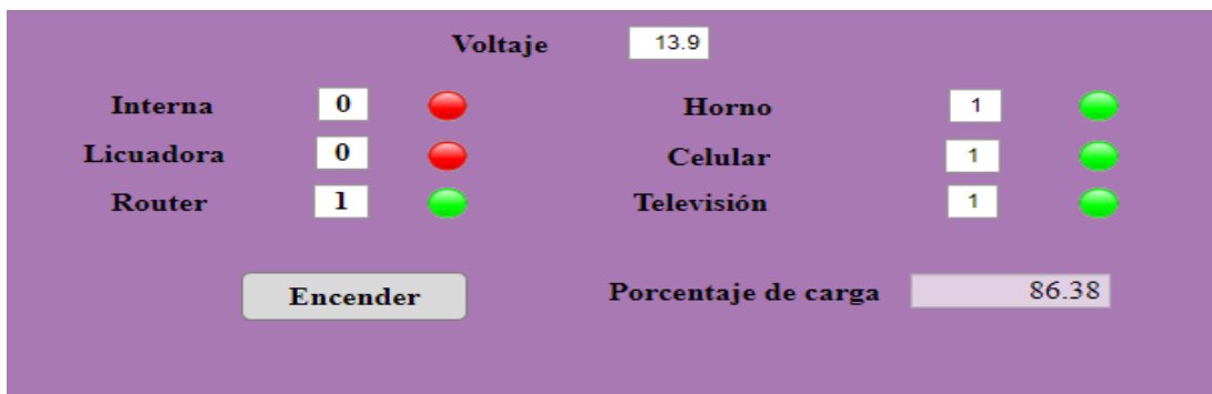
Figura 40 Caso práctico enfocado al sistema que se tomó como base para el dimensionamiento, primera situación, voltaje alto encendido solicitud de encendido cuatro de seis cargas (elaboración propia Matlab 2022 academic)
