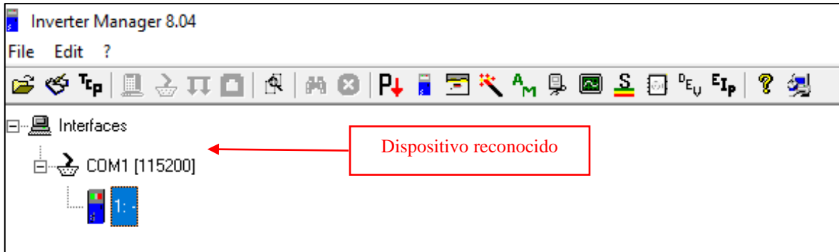
Figura 47.- Reconocimiento del dispositivo
