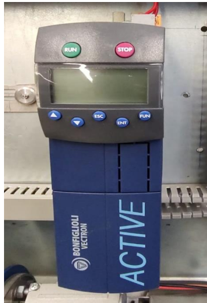
Figura 37.- Variador Bonfiglioli Vectron ACTIVE ACT400
