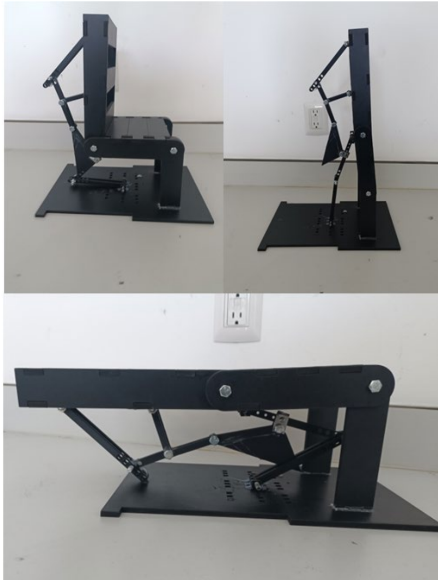
Figura. 31 Segundo prototipo en las tres funciones de operación sedestación, bipedestación y decúbito supino.
