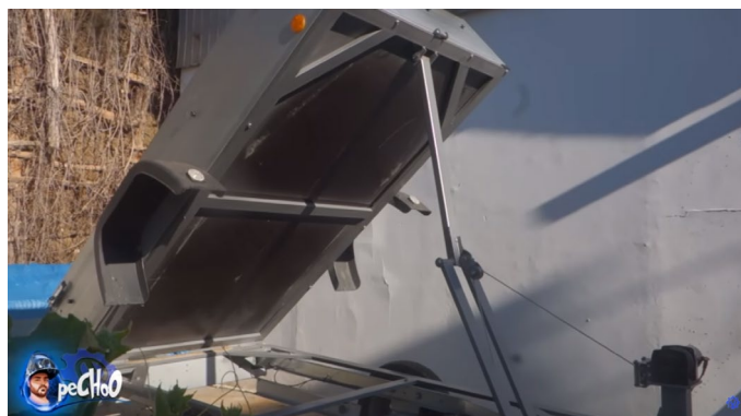
Figura. 14 Ejemplo de mecanismo basculante realizado con eslabones [36].
