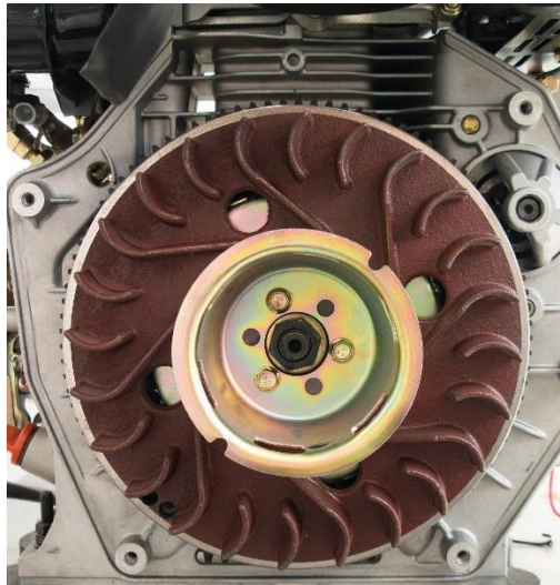
Figura 32.- Sistema de enfriamiento de convección forzada acoplado al volante de inercia del motor desarrollado.
