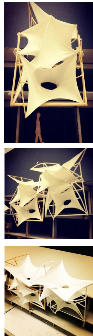
Fig. 4.4.6a Modelos a escala para observar su comportamiento con la estructura en el edificio
