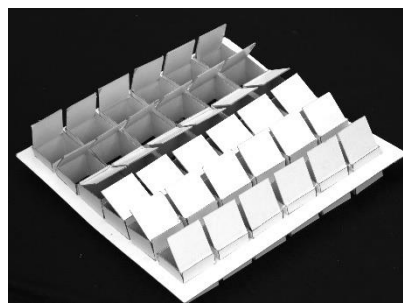
Fig. 4.3.2a y Fig. 4.3.2a Patrones bidimensionales adaptables analógicos. Promueve las funciones de flujos del viento y radiación.
