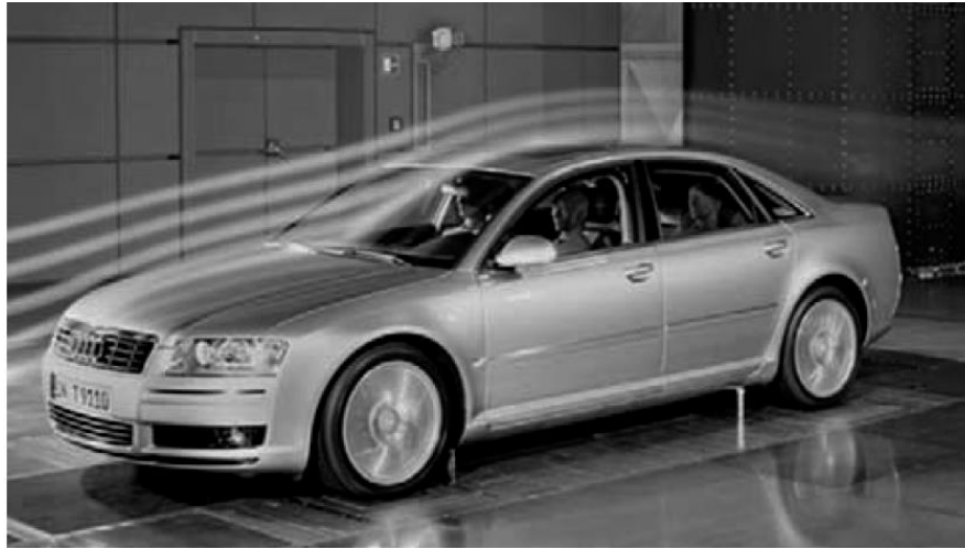
Figura 4.25 Túnel de viento para conocer de forma aproximada la fuerza que el aire ejerce contra el desplazamiento del vehículo [43]
