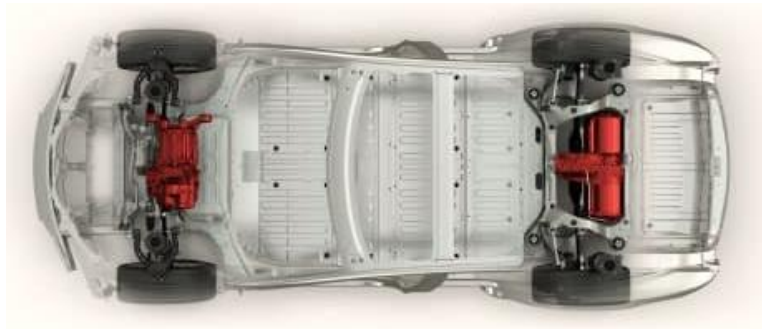
Figura 3.2 Vehículo Tesla modelo S, con motor trasero más grande que el motor frontal [36]
