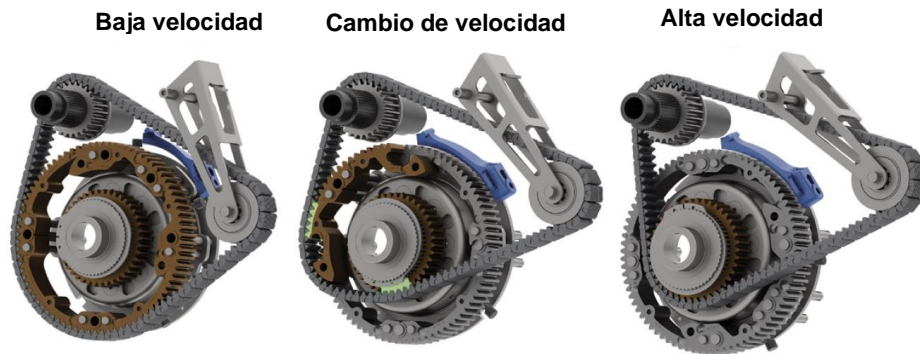
Figura 2.5 Sistema de tracción de dos velocidades, desarrollado por la empresa canadiense Inmotive Inc. [21]
