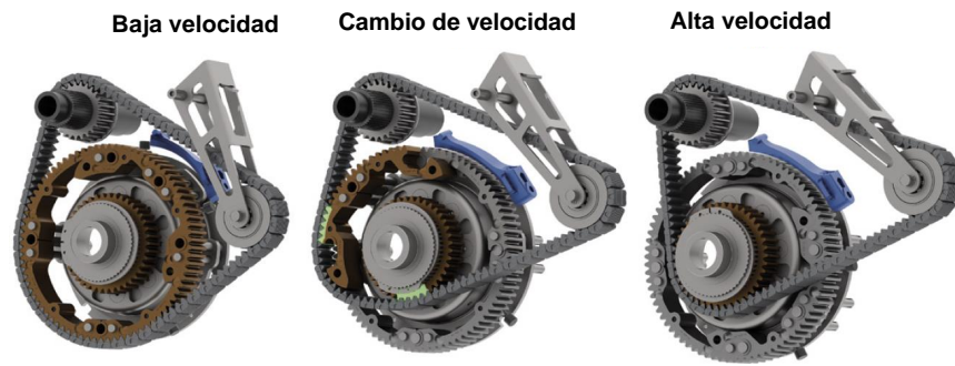
Figura 3.15 Sistema de transmisión de dos velocidades, con engranes particionados [21]
