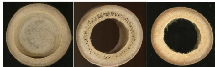
Figura 5 (Izq.) Guadua aculeata , altura entre 10 y 20 m, diámetro entre 10 y 15 cm, (Cen.) Guadua amplexifolia , altura entre 10 y 12 m, diámetro entre 8 y 12 cm y (Der.) Guadua velutina , altura hasta 15 m, diámetro entre 8 y 12 cm
