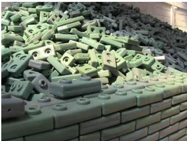
Imagen 9. Fabricacion de bloques de plástico. Cero's (Esnavi Constructora, 2018).
