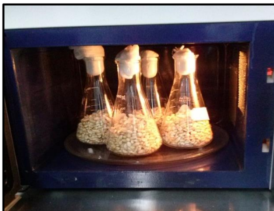
Figura 9. Esterilización del maíz en horno de microondas.
