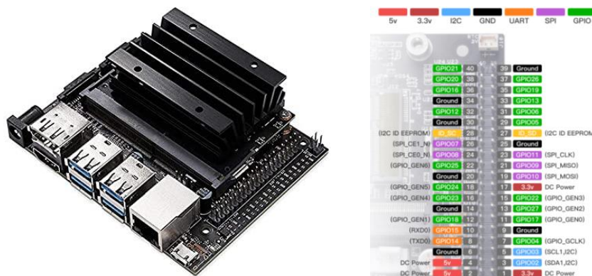
Figura 12. a) Jetson Nano, b) conectores de propósito general GPIO.
