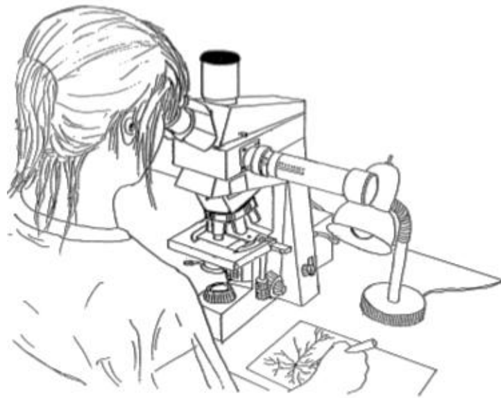
Figura 7. Método para dibujar las neuronas piramidales. Se ilustra el microscopio óptico acoplado a una cámara lucida, por la cual se observan las neuronas y se dibujan para su posterior análisis, (Tomado y modificado de Kolb et al. , 1998).
