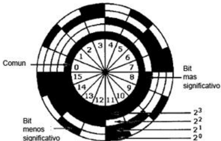
Figura 2.9 Disco de Encoder absoluto (S/A, www.tecnoficio.com )
