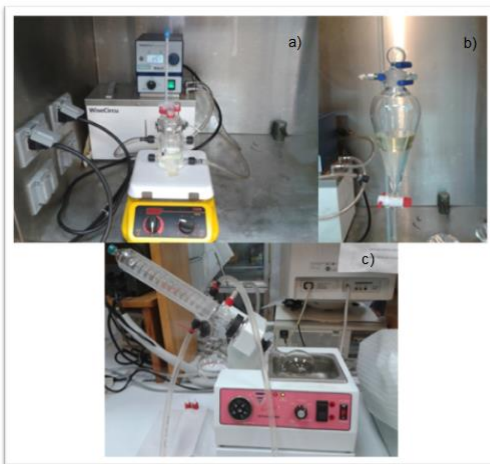
Fig. 6: Método para la extracción de productos de la oxidación de fármacos catalizada con cloroperoxidasa: a) reacción en 50 mL, b) extracción con acetato de etilo, c) evaporación del disolvente.
