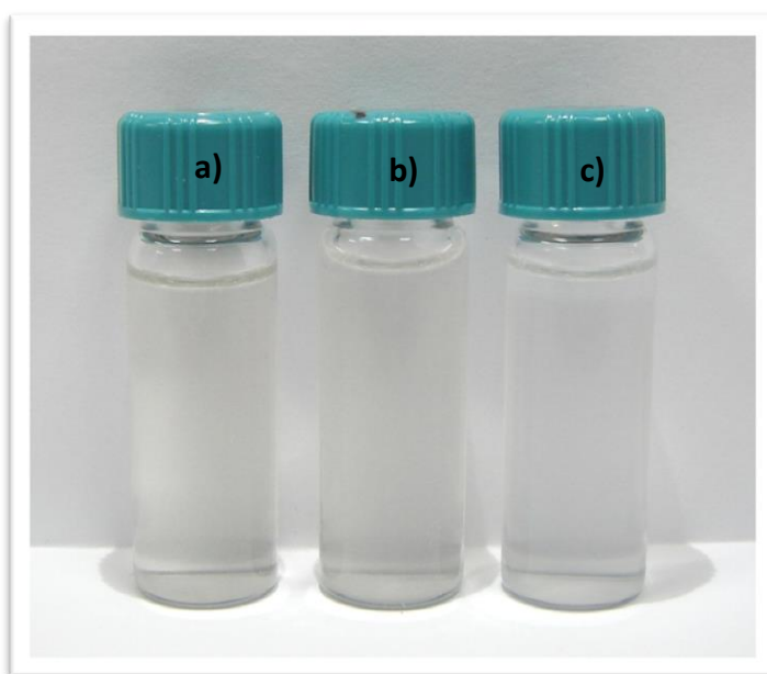
Fig. 16: Variación de color y turbiedad de las tres diferentes muestras analizadas: a) agua residual sin oxidar, b) agua residual pH 3 y c) agua residual luego de la reacción 1h.
