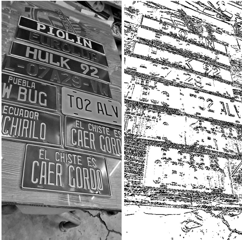
Figura 5.9: Ejecución del filtro vertical de Sobel.
