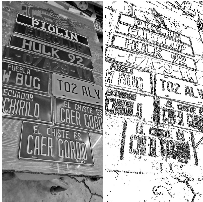
Figura 5.8: Ejecución del filtro horizontal de Sobel.
