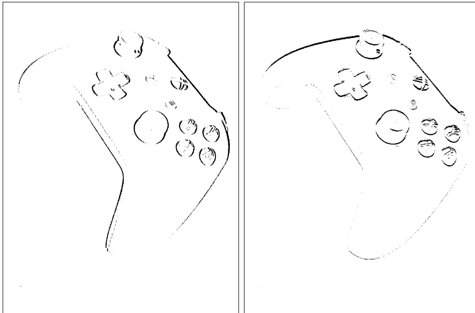
Figura 5.19: Ejecución de procesamiento por diferencias hacia adelante, a la izquierda el filtrado horizontal, a la derecha el vertical.
