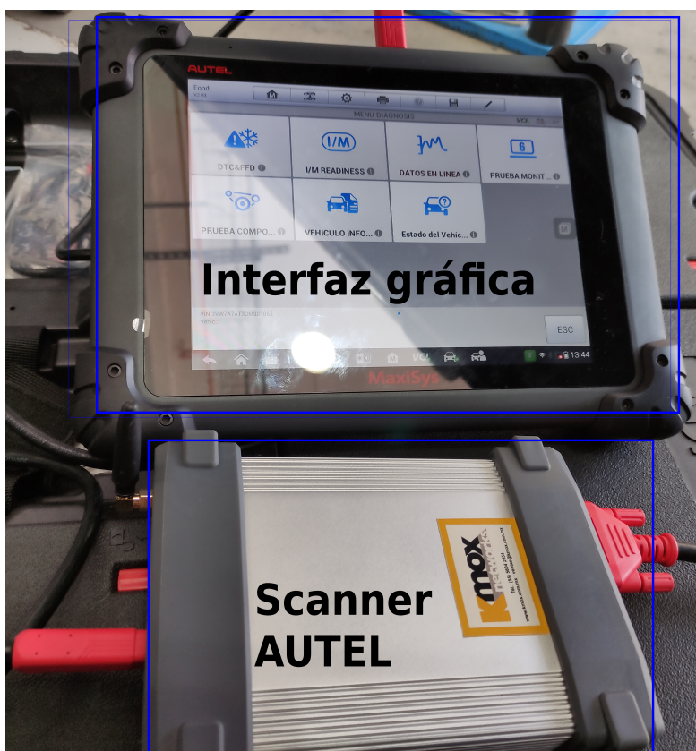
Figura 5.8: Escáner AUTEL MaxiFlash Elite y su interfaz gráfica.
