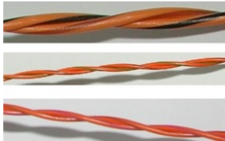
Figura 2.4: Colores típicos de cable CAN Bus [5].
