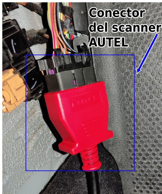
Figura 5.9: Conexión del escáner AUTEL MaxiFlash Elite al OBD-II del Volkswagen Beetle.
