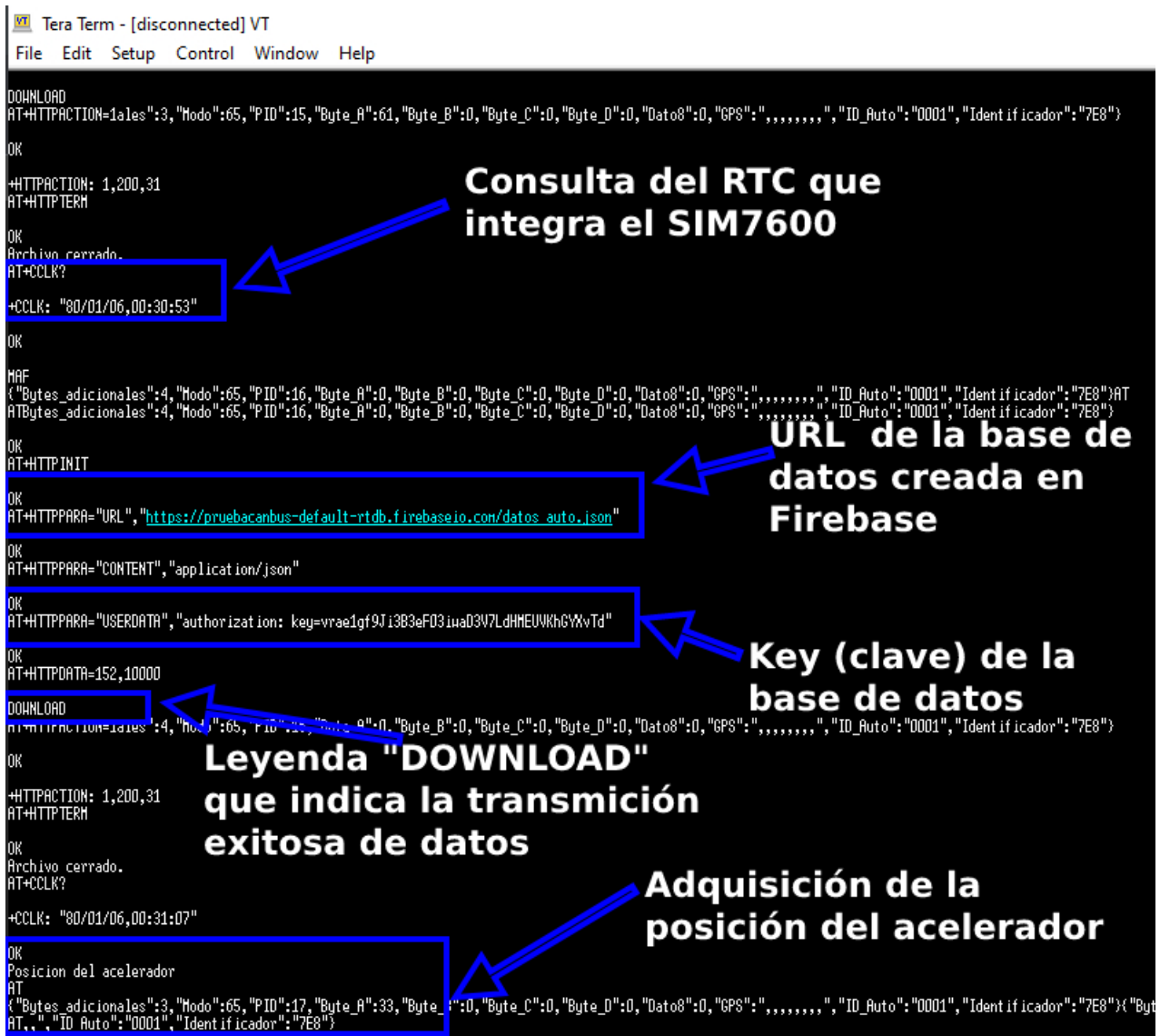
Figura 3.31: Captura de pantalla del monitor serial TeraTerm , donde se visualiza los comandos AT y sus respectivas respuestas.
