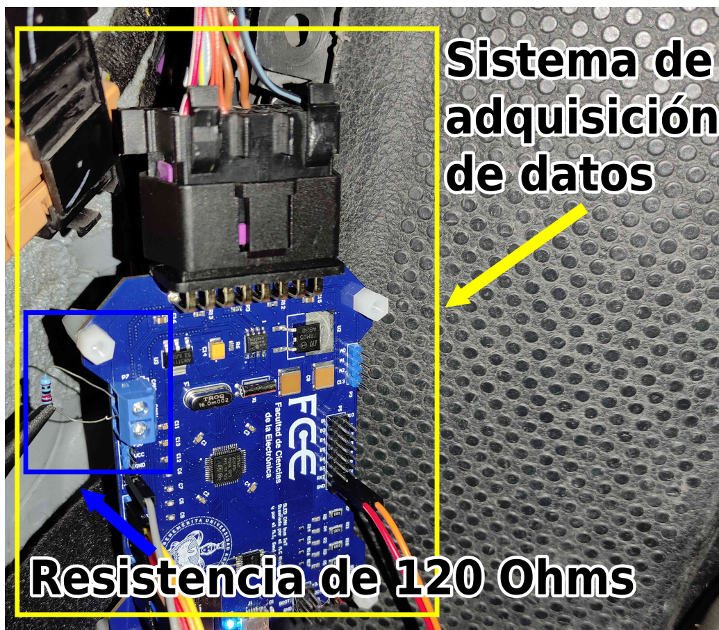
Figura 5.7: Conexión del SADO al OBD-II del Volkswagen Beetle 2013.
