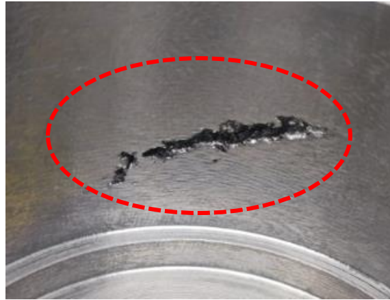
Figura 25. Pieza con defecto de contracción (rechepe)
