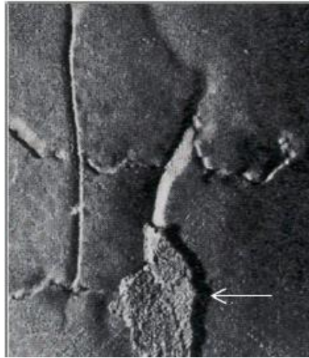
Figura 27. Colas de rata en superficies planas de fundiciones de hierro
