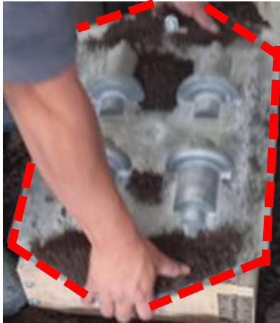
Figura 18. Ejemplo de un prototipo utilizado para reproducir piezas por arena
