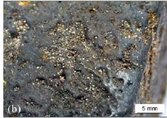
Figura 23. Inclusión de arena a 5 mm en una fundición de hierro gris producida en un molde seco de arena verde
