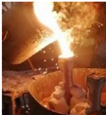
Figura 16. Colada de metal fundido en conchas cerámicas
