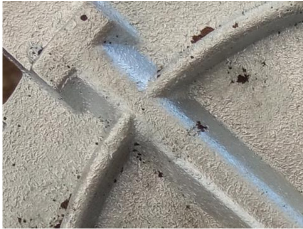
Figura 31. Superficie rugosa de una pieza de aluminio
