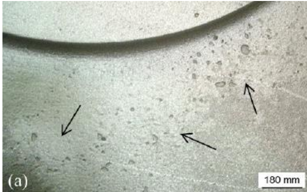
Figura 22. Inclusión de arena a 180 mm en una fundición de hierro dúctil de sección gruesa
