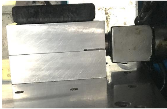
Figura 9. Inyección de cera en molde de aluminio
