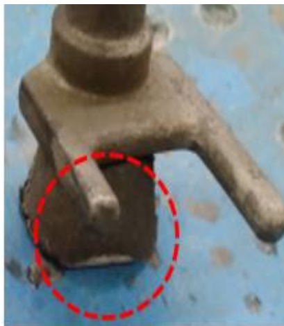
Figura 32. Pieza incompleta debido a la falta de material
