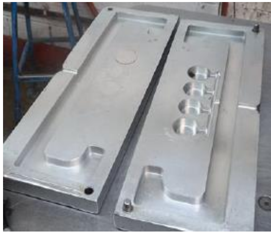
Figura 8. Interiores de un molde de aluminio
