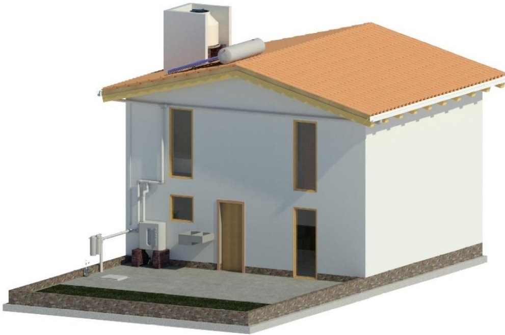
Imagen 4.3.1.3. Vista tridimensional sistema de captación pluvial.
