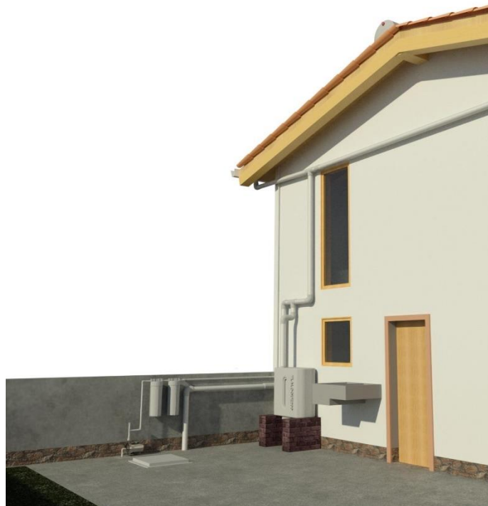
Imagen 4.3.1.4. Vista tridimensional sistema de captación pluvial.
