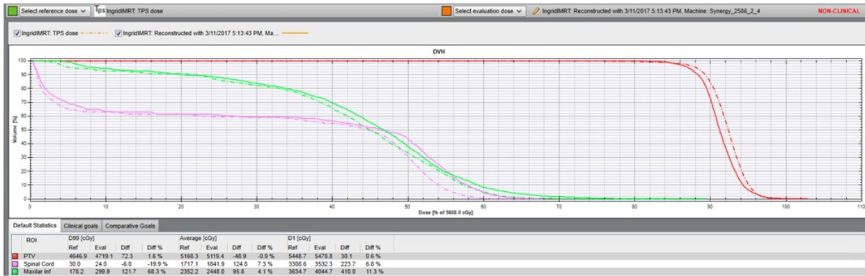
Figura 5.20: Histograma dosis-volumen proporcionado por COMPASS en donde se observa la comparación entre TPS vs CR(DT) para un caso de cáncer de cabeza y cuello tratado con la técnica de IMRT. La línea punteada corresponde al TPS, mientras que la línea sólida corresponde al cálculo realizado por el software a partir de la fluencia medida por el detector de transmisión.
