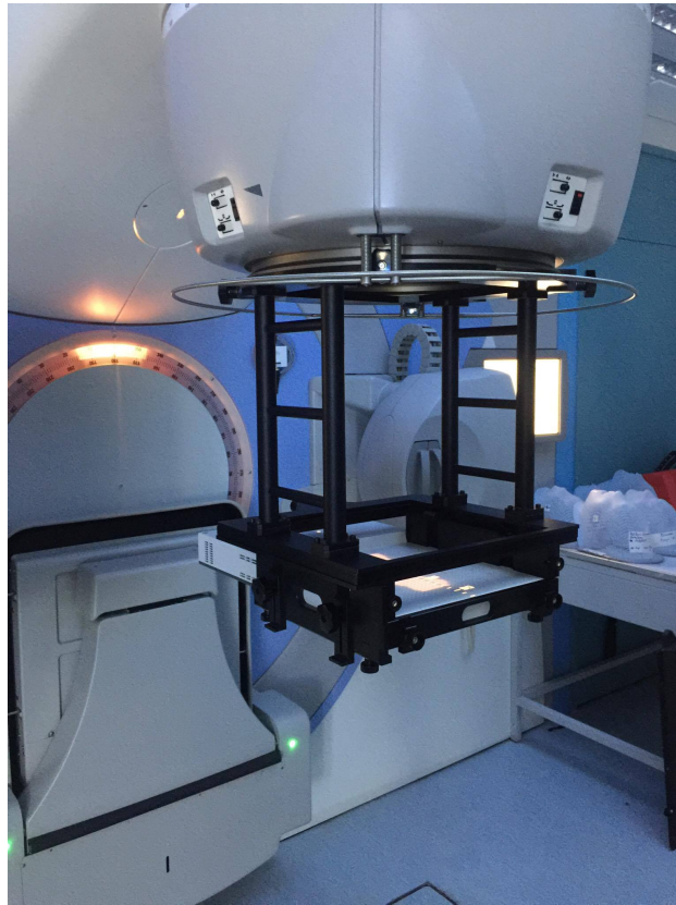
Figura 4.4: Arreglo experimental para mediciones con el detector MatriXX y el software COMPASS
