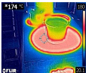
Figura 92. Ebullición del agua en segunda fase, estufa Patsari. Fuente: Propia.
