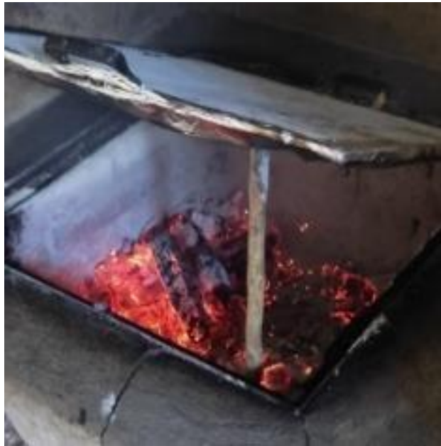
Figura 45. Cámara de combustión de estufa Albalat. Fuente: Propia.
