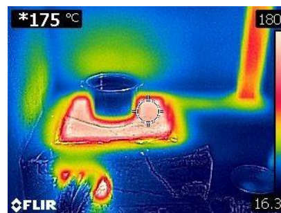
Figura 87. Ebullición del agua en primera fase, estufa Albalat.
