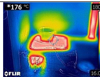
Figura 91. Ebullición del agua en segunda fase, estufa Albalat. Fuente: Propia.
