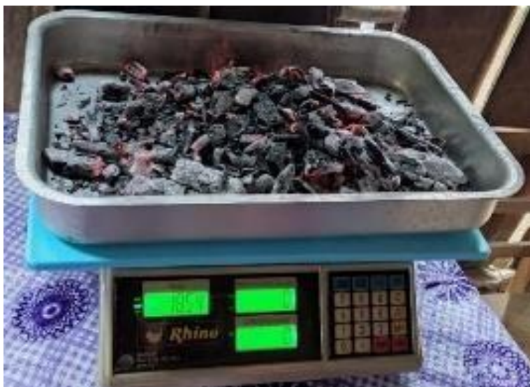
Figura 46. Puntas de madera y carbón de estufa Patsari. Fuente: Propia.
