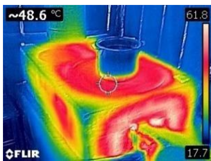
Figura 84. Estufa Patsari, temperatura elevada en primera fase.
