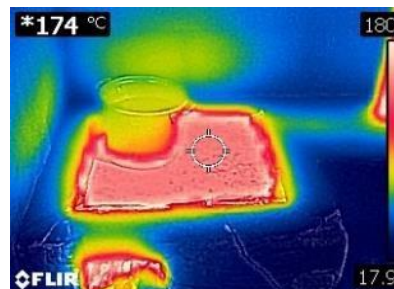
Figura 85. Estufa Albalat, temperatura elevada en primera fase.
