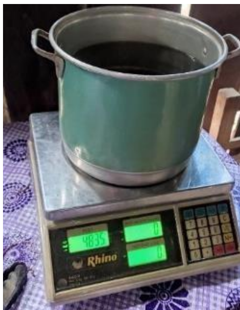
Figura 58. Olla con agua fría para iniciar tercera prueba en estufa Patsari. Fuente: Propia.
