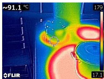
Figura 90. Ebullición del agua en segunda fase, estufa Patsari. Fuente: Propia.
