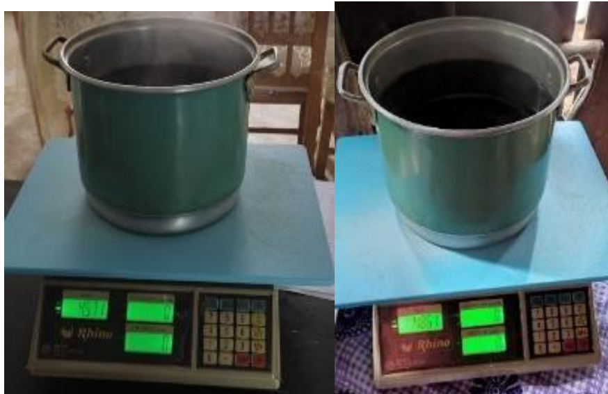
Figura 49. Peso de olla con agua hirviendo en ambas estufas.
