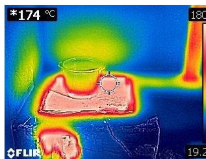
Figura 93. Ebullición del agua en segunda fase, estufa Albalat. Fuente: Propia.
