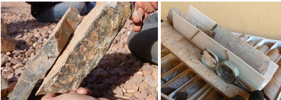
Figura 5.13. Ensayo de campo Tilt-test (Barton 1981)
