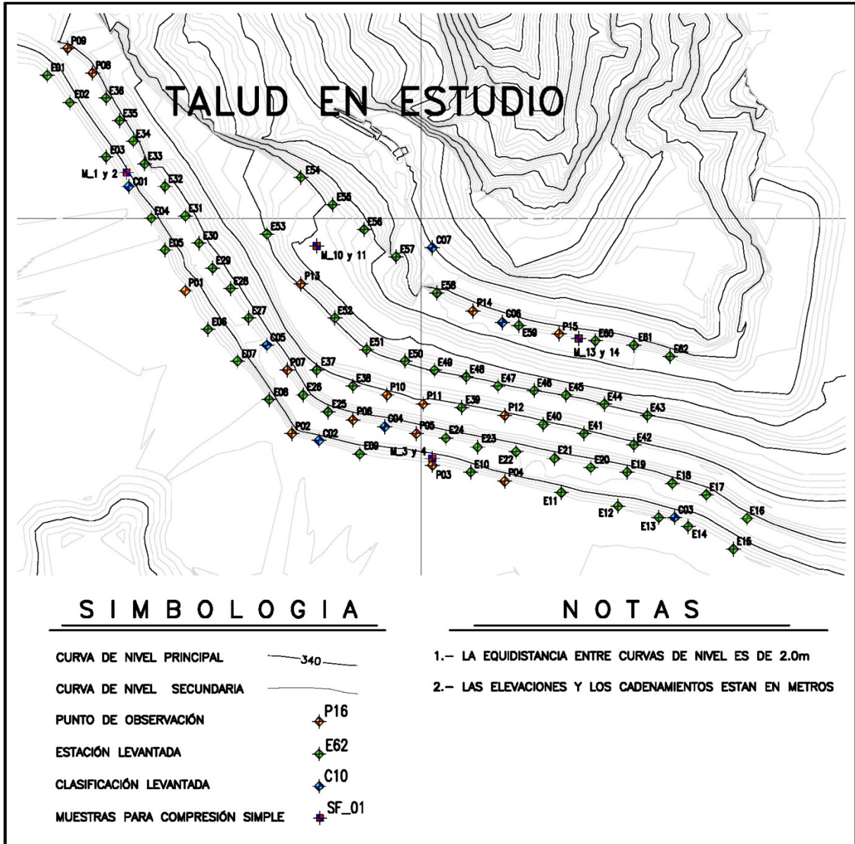
Figura 4.3 Trabajos de caracterización realizados en el talud en estudio
