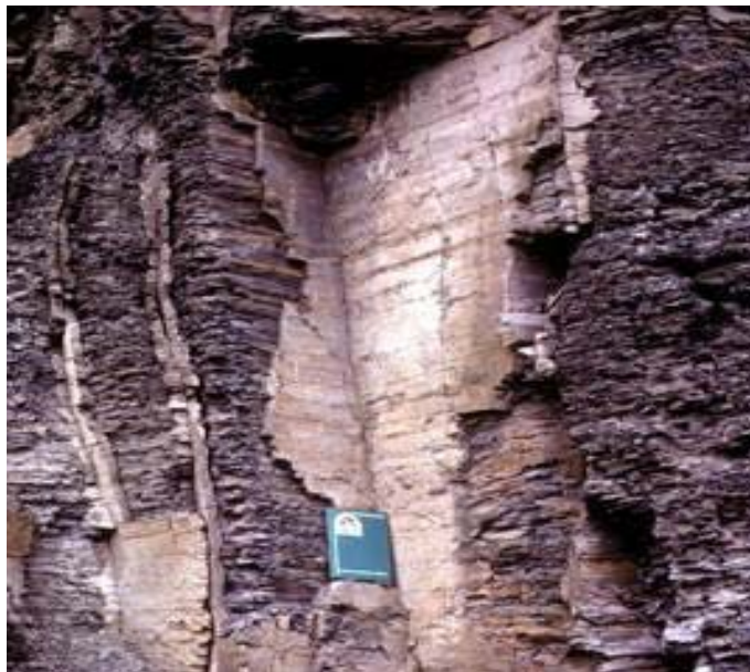
Figura 2.2. Rotura plana en roca Tomado de Yonathan Admassu
