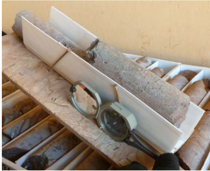
Figura 4.7. Ensayo de campo Tilt-test (Barton 1981)
