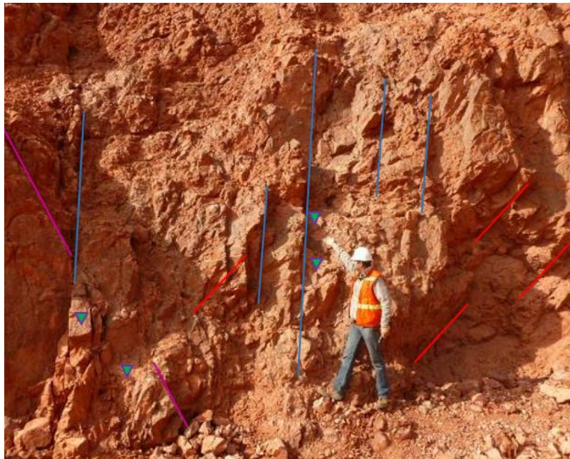
Figura 5.3. Afloramiento de riolita fluidal y brecha riolítica con las principales familias de discontinuidades
