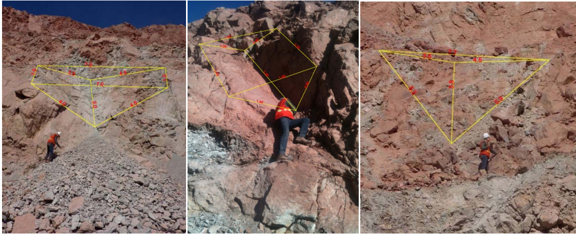
Figura 6.2 Mecanismos de roturas locales detectados en los bancos del talud en estudio
