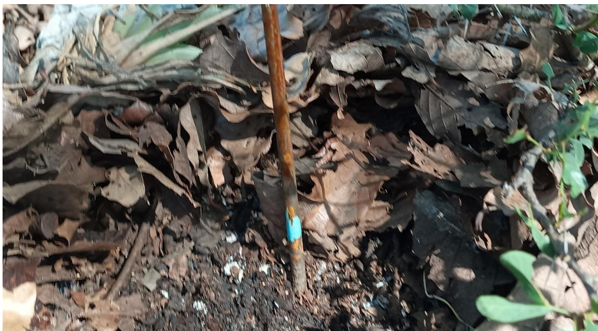
Imagen 34. Clavo para medir la erosión de hídrica
