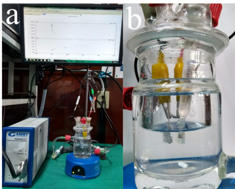
Fig. 3.2 a) Sistema de electrodeposición, b) celda electroquímica y arreglo de tres electrodos.
