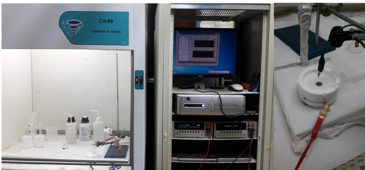
Fig. 3.4 Sistema de fabricación de estructuras de silicio poroso. Izquierda: Campana de extracción de humos. Centro: Fuente, multímetro y PC. Izquierda: Celda electroquímica.
