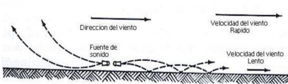
FIGURA 21. Referencia sobre el efecto de la dirección del viento en la propagación de los rayos de sonido. (Es exagerada la escala vertical)
