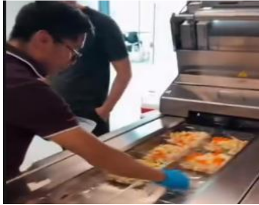
Figura 20 Colocación de verduras en charolas de termo selladora.
