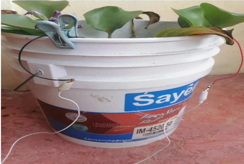
Figura 11. Prototipo 5 de celda de combustible microbiológico
