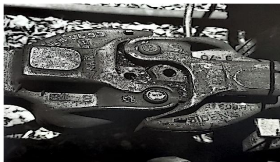
Imagen 100. Fotografía de pernos de enganche Alberto Vital. (2010). "Muela con pernos". Las vías del tiempo , p.67.
