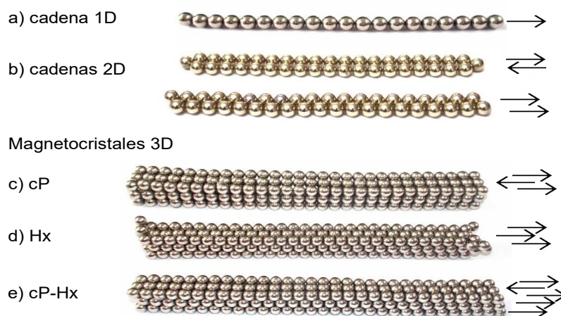
Figura 2.5: Ensamblajes de esferas magnéticas: a) cadena lineal, b) lámina cúbica y hexagonal, c) cristal cúbico, d) cristal hexagonal y e) cristal híbrido. Las flechas en color negro indican la dirección de los momentos dipolares.
