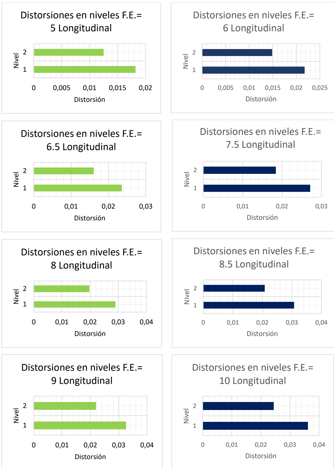
Figura 5.9.2. Distorsiones de entresijos para cada factor de escala, sentido longitudinal
