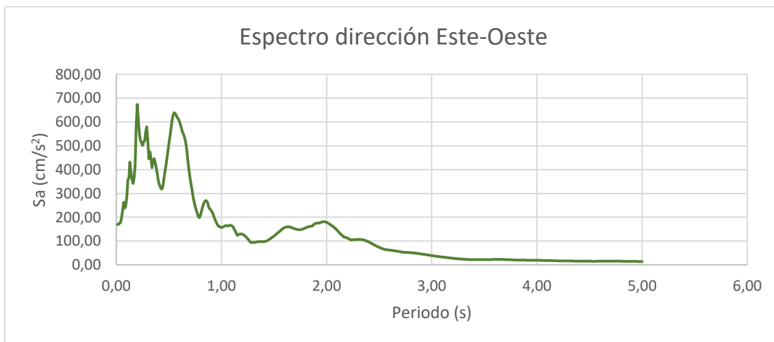
Figura 5.7.1. Espectro de pseudo aceleraciones dirección Longitudinal, sismo 19/11/17.
