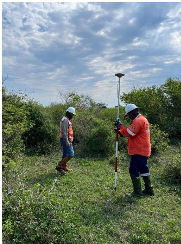
Figura 40. Localización de puntos de referencia con GPS.
