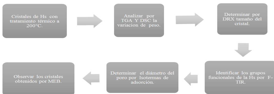
Fig. 6 Descripción del proceso de análisis de las propiedades de la Hs, luego ser sometida a tratamiento térmico a 200°C
