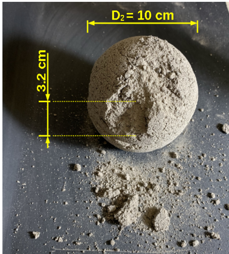
Figura 4.8: Secuencia del impacto horizontal de proyectiles con m_1 < m_2 a) granular vs granular y b) granular vs sólido. En la parte inferior se encuentran los escombros del proyectil impactante, así como del impactado.
