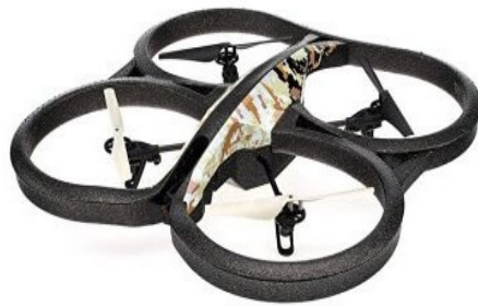
Figura 2-1: Dron de ala rotativa conocido como AR Drone 2.0 de la compañía Parrot.
