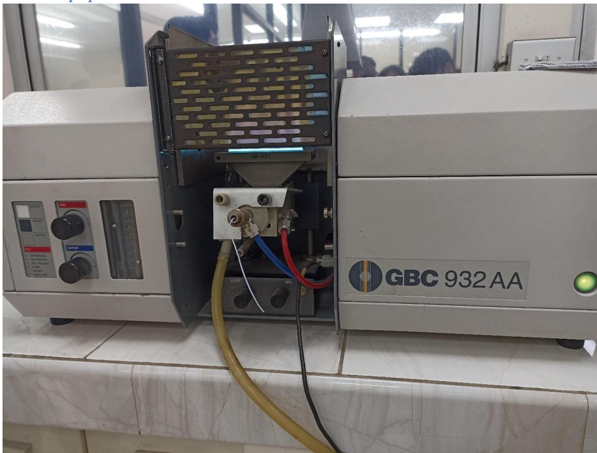
Figura 24. Espectrofotómetro de absorción atómica GBC 932 de marca Scientific Equipment Ltd.
