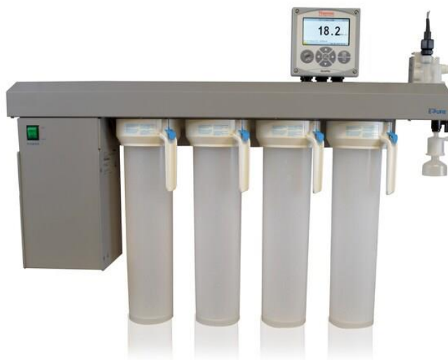
Figura 19. Sistemas de purificación de agua ultrapura Barnstead™ E-Pure™.
