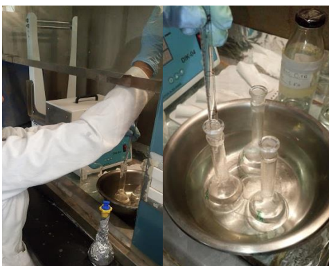
Figura. 2.5.3.1. Proceso de inversión de los azúcares en el licor de toronjil. Fuente: propia.
