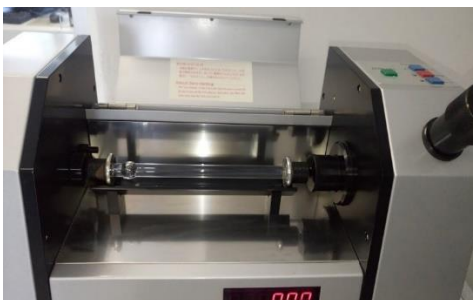
Figura. 2.5.3.2. Medición del ángulo de rotación para la determinación de sacarosa. Fuente: propia.
