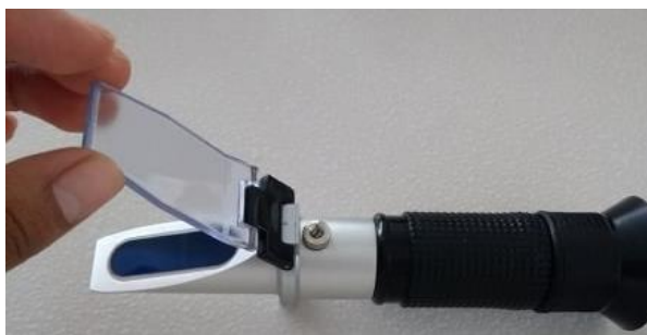
Figura. 2.5.2.1. Determinación de sólidos solubles totales. Fuente: propia.
