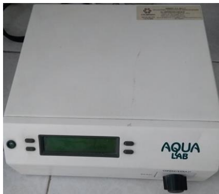
Figura. 2.3.3. Determinación de la actividad de agua ( a_w ). Fuente: propia.
