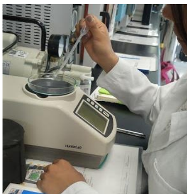
Figura. 2.5.6.1. Determinación de color. Fuente: propia.
