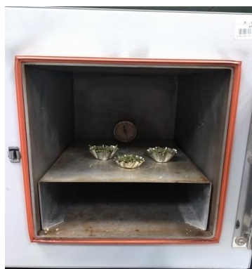
Figura. 2.3.2. Determinación del porcentaje de humedad de la materia prima deshidratada. Fuente: propia.
