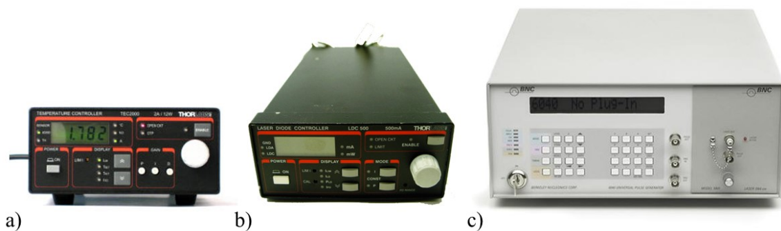
Figura 3.3. Sistema de estabilización del láser de alta ganancia. a) Control de temperatura, b) control de corriente y c) generador de pulsos.
