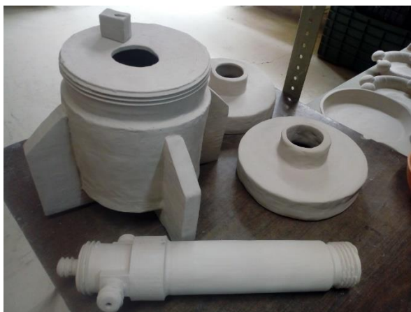
Fig. 26. Piezas terminadas del reactor
