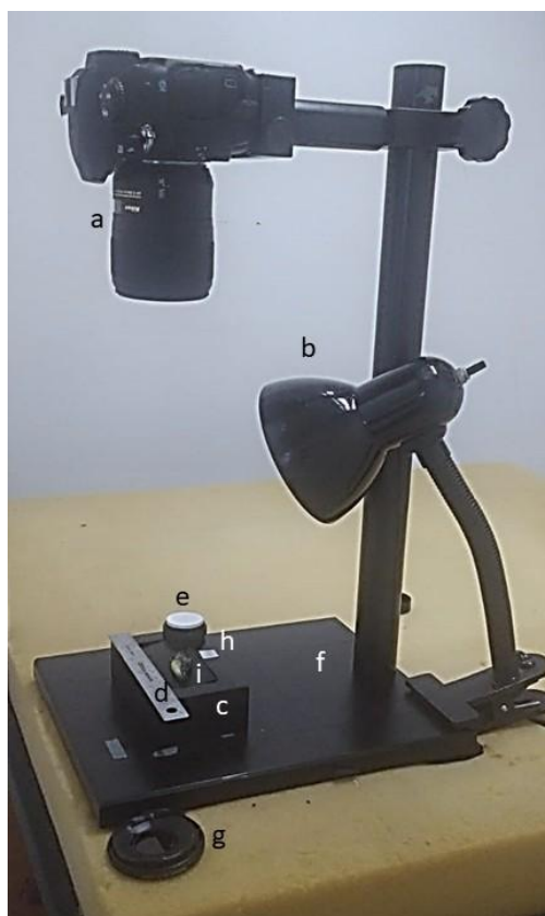
Figura 2. Fotografía del arreglo para tomar las fotografías de los peces. a) una cámara fotográfica modificada NIKON D-200; b) una lámpara de cono con foco ultravioleta (365-700 nm); c) una tina anodizada; d) una regla; e) una referencia de color blanco difuso labsphere USRS-99-010 AS-01158-060; f) un soporte para la cámara fotográfica; g) un filtro UV-Venus (300-400 nm); h) una etiqueta de identificación del pez; i) un pez X. variata anestesiado.
