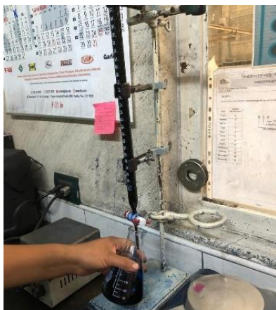
Figura 12. Titulación de azul de metileno (fotografía tomada por el autor)
