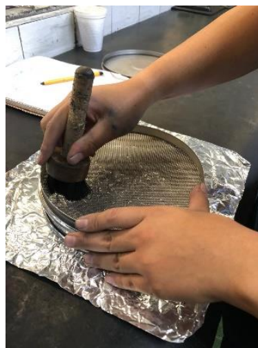
Figura 16. Cepillado de tamiz para obtener el peso retenido (fotografía tomada por el autor)
