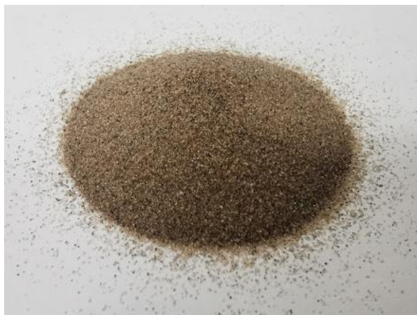
Figura 4. Arena de zirconio (Zirconium Sand, “Arenas de circon,” [En línea]. Disponible en: https://sp.zirconiumsand.com/product/arenas-de-circon/ )
