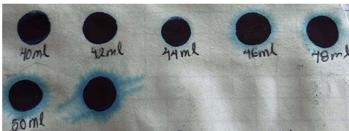
Figura 30. Mililitros de azul de metileno ocupados después del cambio (fotografía tomada por el autor)
