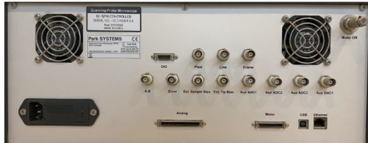
Figura 2.4: Visión trasera de los canales de salida y entrada del controlador SPM.
