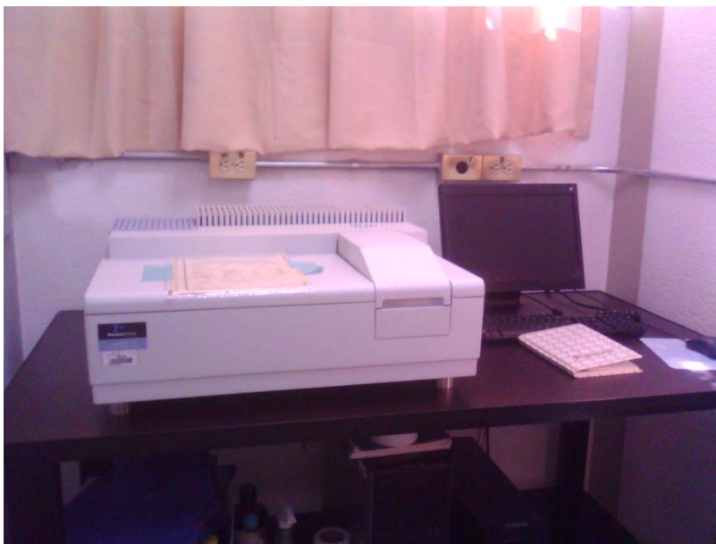
Figura 2.4. Espectrofotómetro UV-Visible ubicado en la Facultad de Ingeniería Química-BUAP, utilizado para el estudio de absorbancia de las nanopartículas de SnS 2 .
