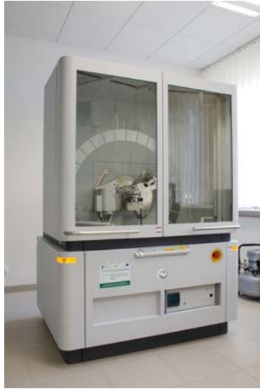
Figura 2.6. Difractómetro PANALYTICAL Empyrean, ubicado en el Laboratorio de Difracción de rayos-X del Instituto de Física-BUAP.
