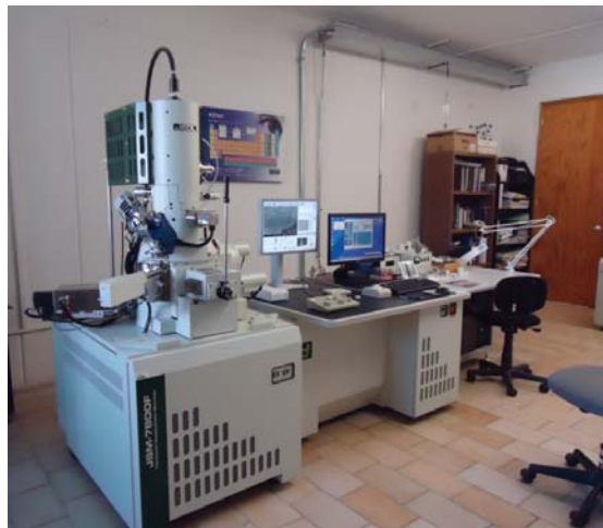
Figura 2.7. Microscopio electrónico de barrido de emisión por campo ubicado en el Laboratorio de Análisis de Superficies del Instituto de Física-BUAP.
